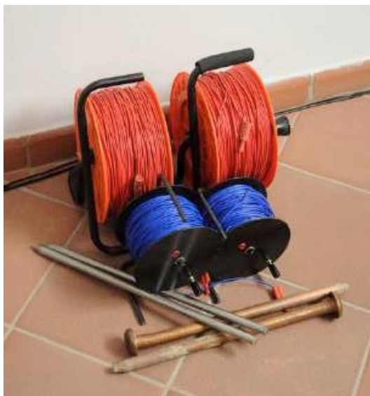
1° Foto: 2 rotelle di cavo da 300 m ciascuna per misure SEV (AB); 2 rotelle di cavo da 50 m per misure SEV (MN). 2° Foto: Asse di battuta per energizzazione orizzontali sormontata da automezzo.
